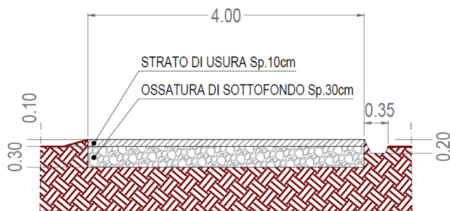
Fig. 3.12 - Sezione di dettaglio della strada interna
