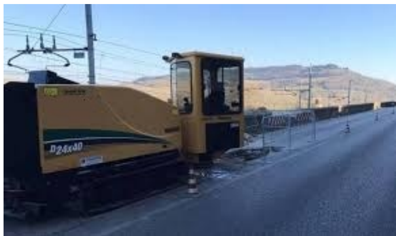
Figura 0-5. Esempio di macchina idonea per la tecnica del no-dig
