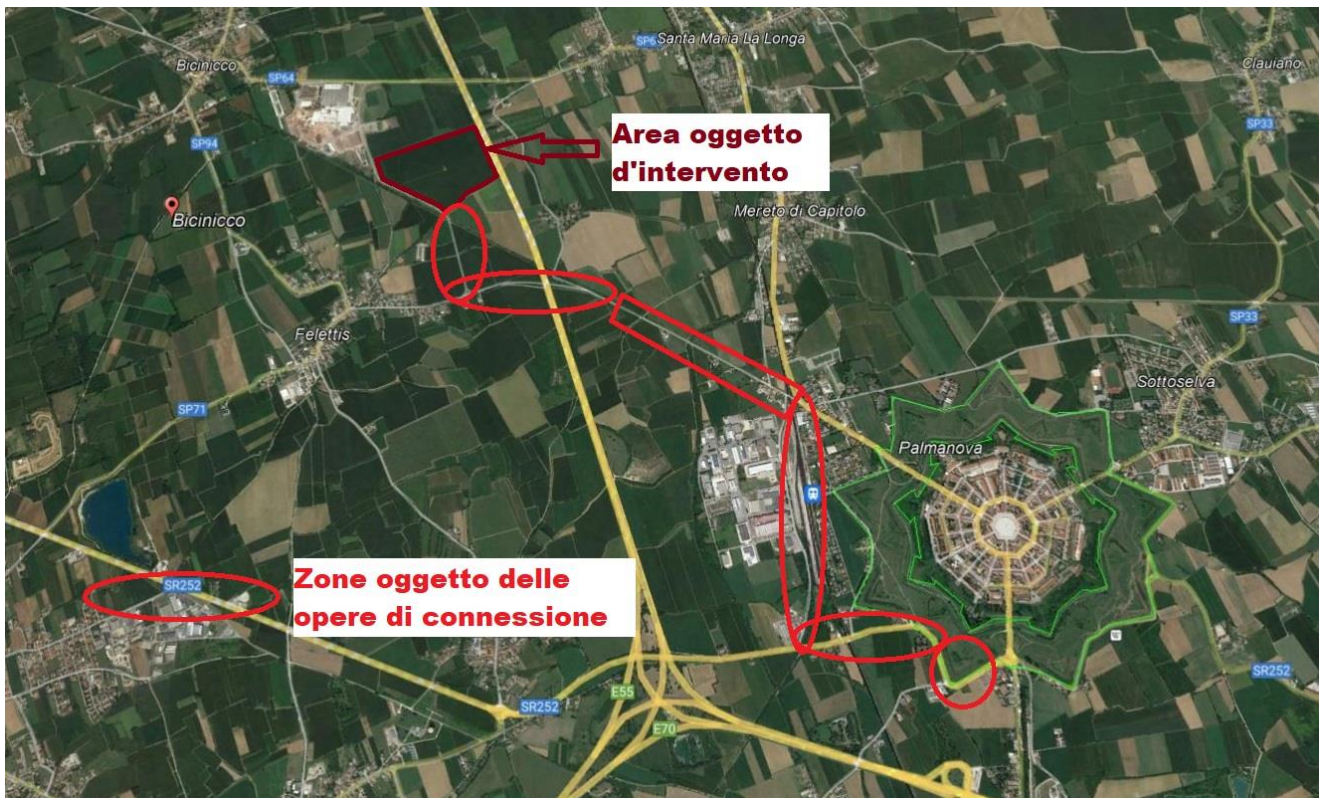
Vista d'insieme dell'impianto di connessione con collegamento cavi MT interrati su base ortofoto
