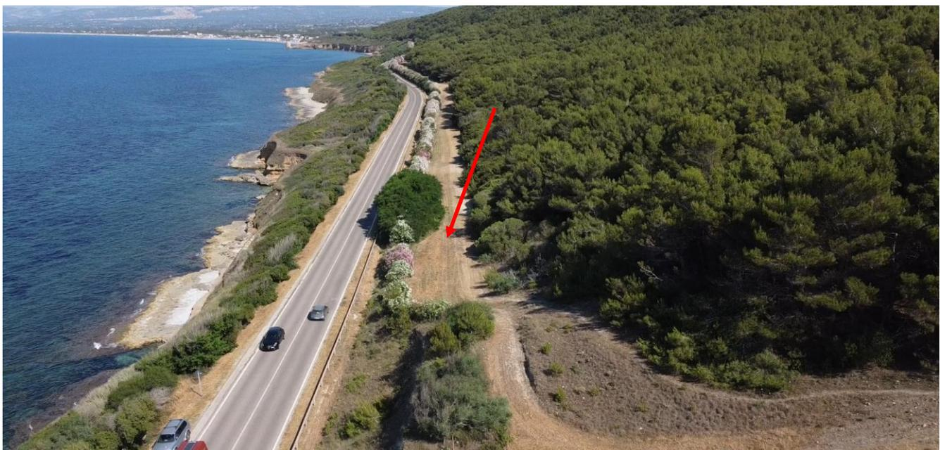
Figura 73 – Ripresa da drone: la freccia rossa indica la linea tagliafuoco su cui passerà la nuova condotta.
