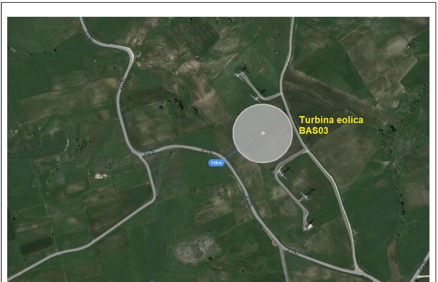
Si segnala comunque l'estrema vicinanza alle strade provinciali e nazionali delle turbine eoliche poste ad una distanza inferiore alla massima gittata calcolata nella "Relazione di calcolo della gittata massima di elementi rotanti per rottura accidentale della pala e suoi frammenti" che nelle conclusioni calcola in **m. 285** la massima gittata in caso di rottura degli organi rotanti.
