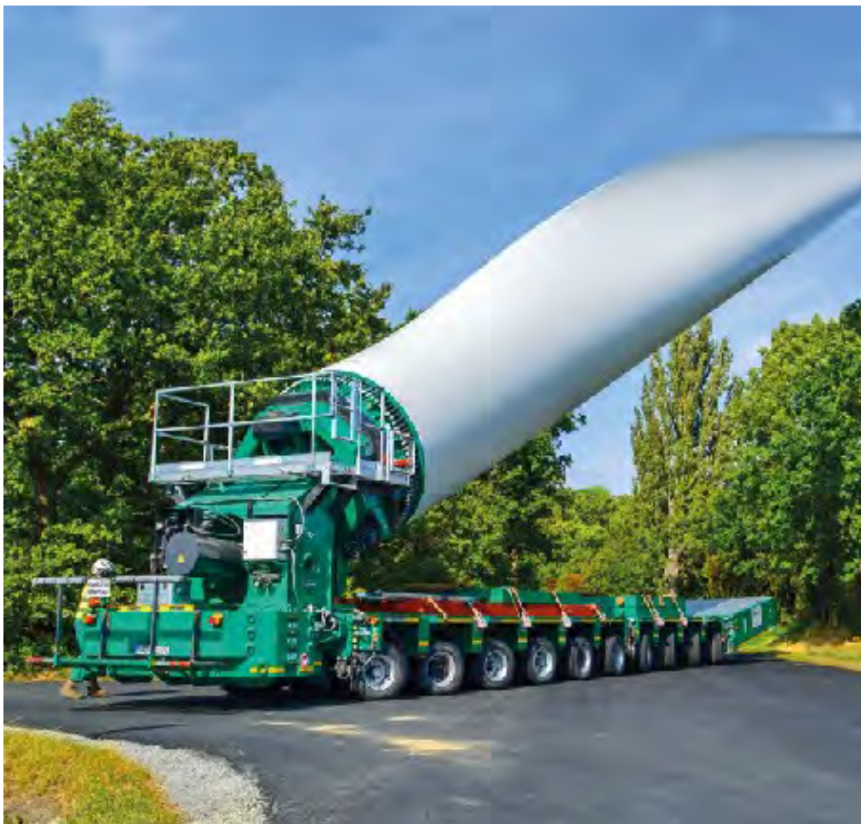
Figura 3 – Blade lifter, utilizzato per il trasporto di pale per aerogeneratori
