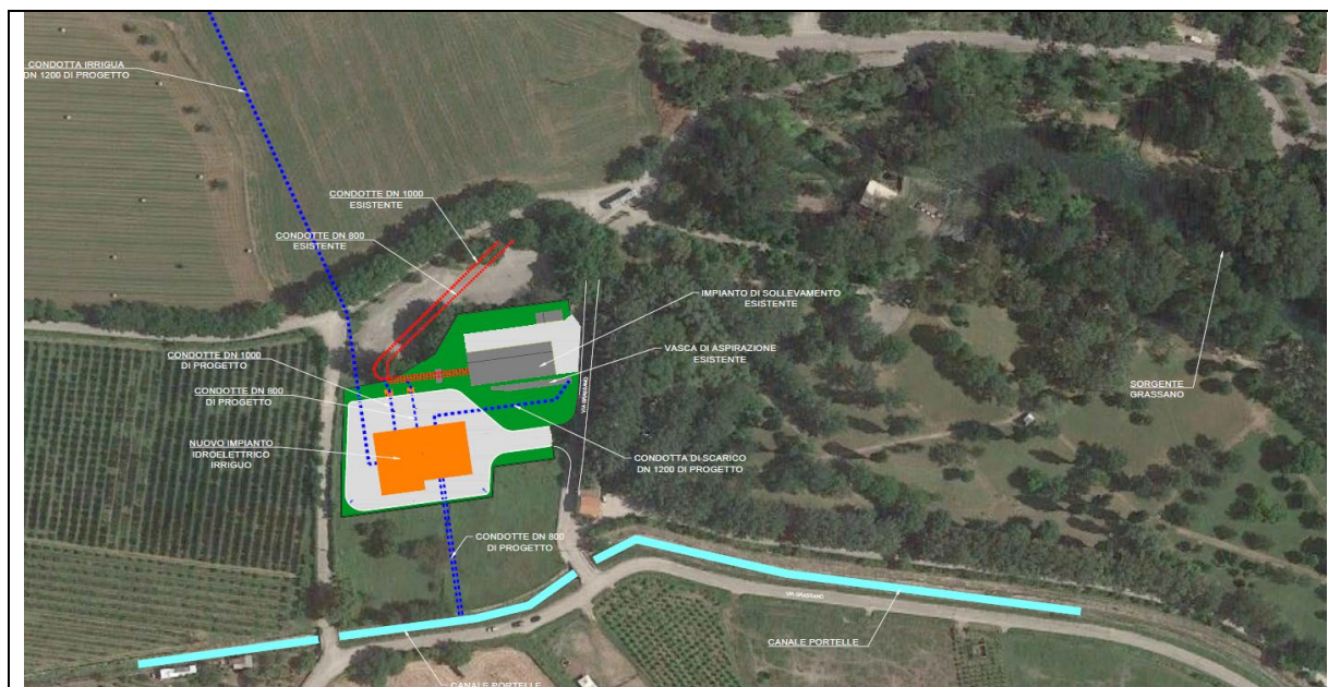
Fig. 6.47- Impianto idroelettrico opere irrigue-planimetria
