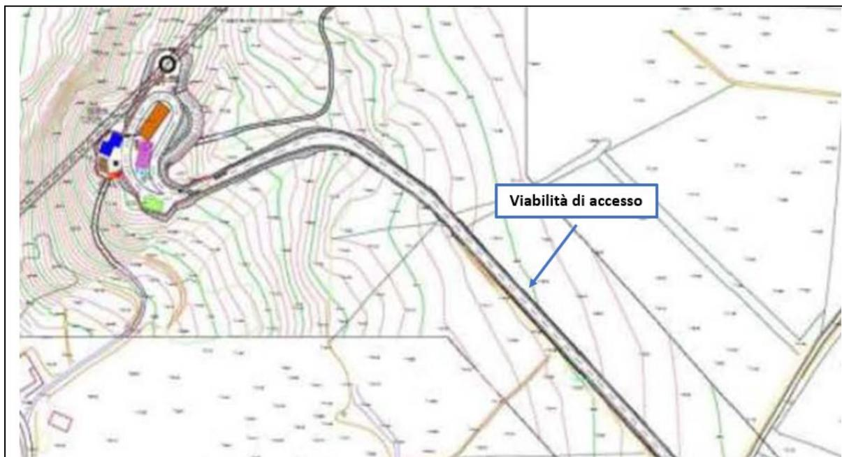
**Fig. 10.8 –Planimetria cantiere pozzo piezometrico con viabilità di accesso**
