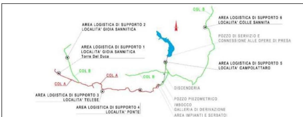
**Fig. 10.13 – Key plan acquedotto con individuazione Aree Logistiche di Supporto e individuazione dei COL - a e COL - b.**
