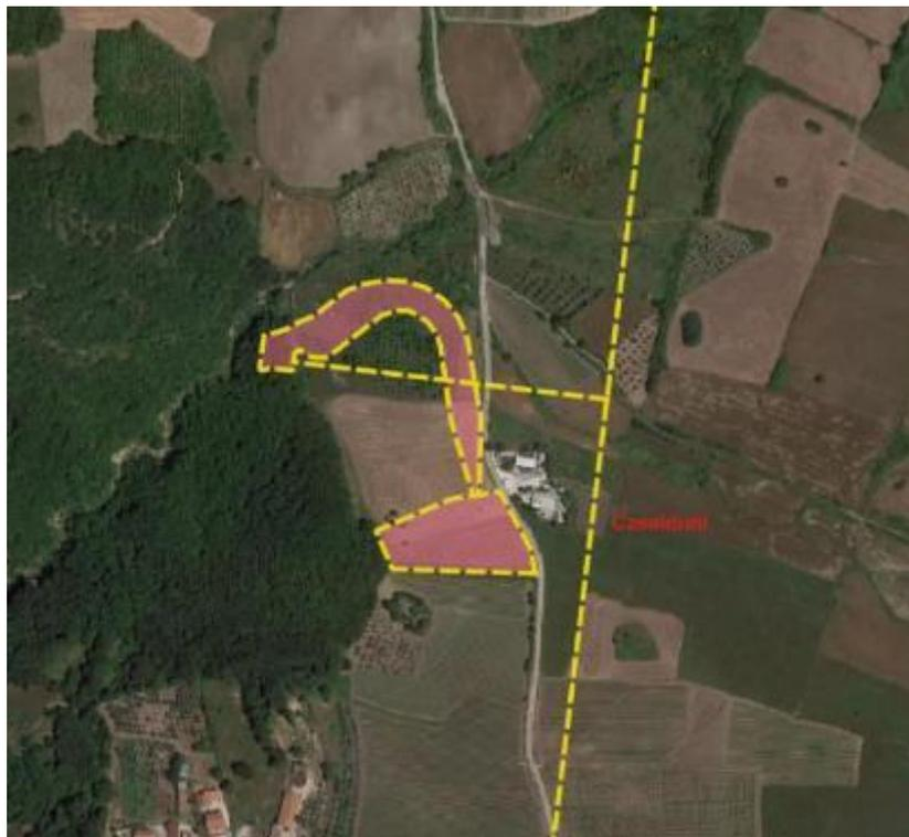
**Fig. 2.102- Area di cantiere per la galleria di accesso laterale**
