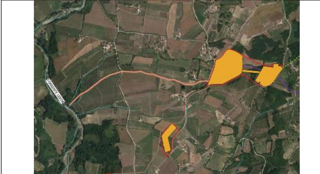
Fig. 2.40 – Mappa delle interferenze tra l'area impianti, la condotta di scarico al ricettore (Torrente Lenta) e il reticolo idrografico
