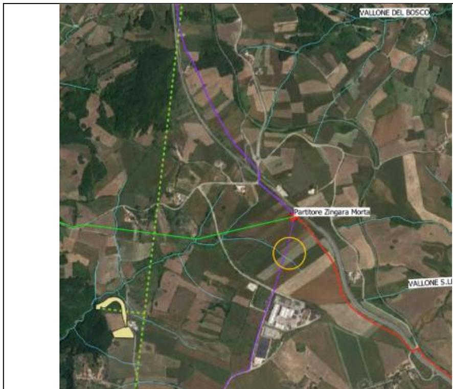
Fig. 2.38 – Mappa delle interferenze tra la *condotta di collegamento Alto Calore* e il reticolo idrografico
