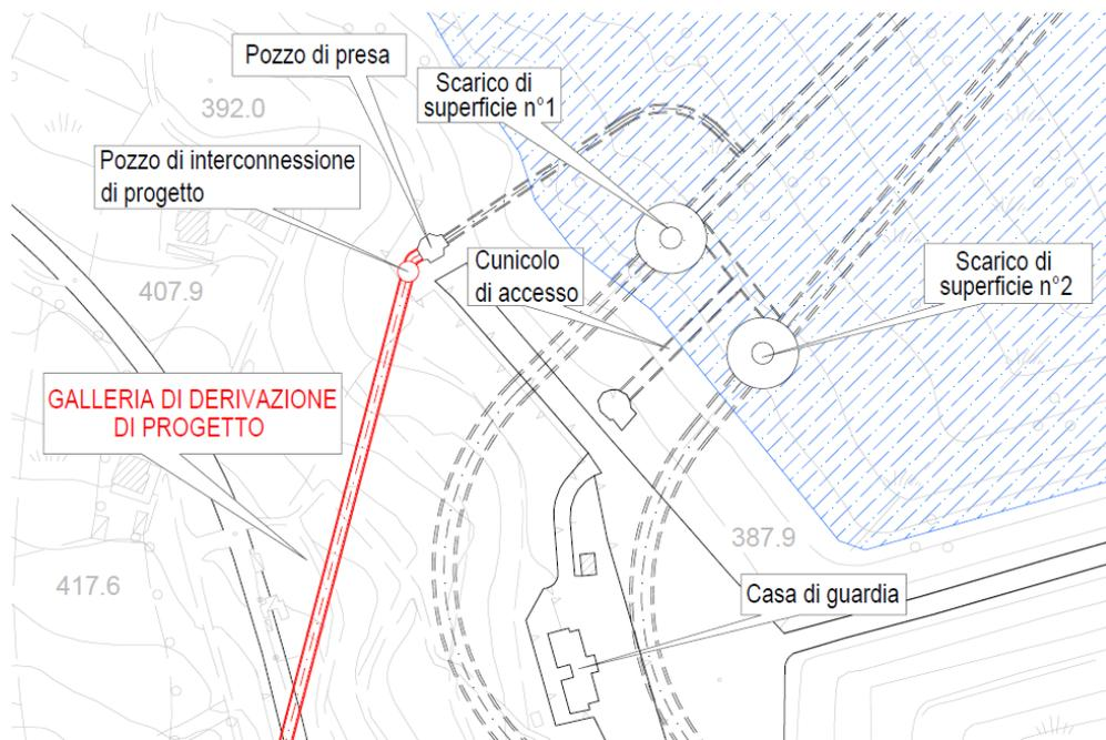
**Fig. 2.118 – Schema collegamento pozzo di derivazione**
