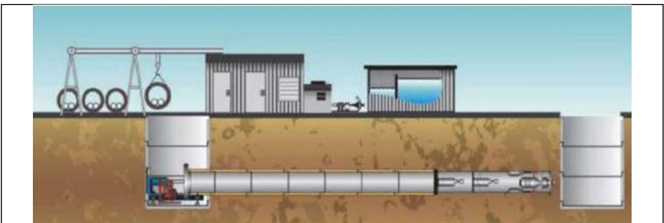
**Fig. 2.51 –Schema di funzionamento micro-tunneling**
