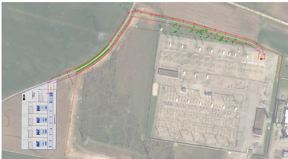
**Fig. 13 – Planimetria generale nuova cabina AT/MT e collegamento in cavo AT – Planimetria di progetto su ortofoto**
