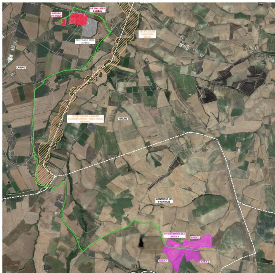
**Fig. 10 – Andamento cavidotto MT su ortofoto**
