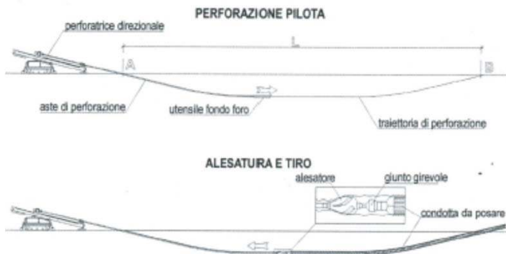
Schema semplificato del sistema di trivellazione T.O.C.
