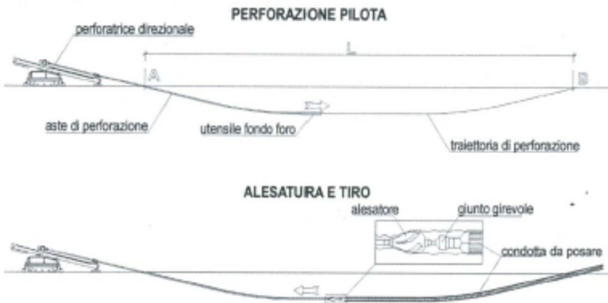
Schema del sistema T.O.C. – Trivellazione Orizzontale Controllata
