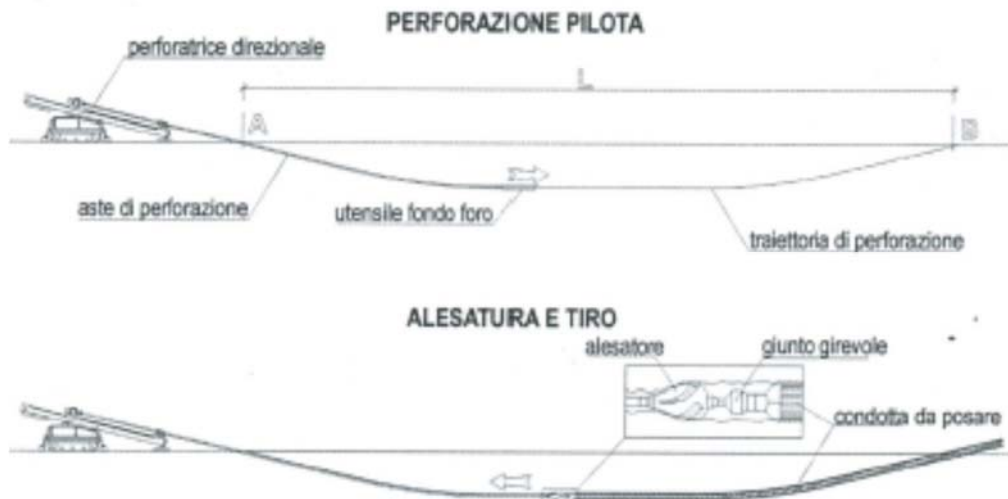
Schema semplificato del sistema di trivellazione T.O.C.
