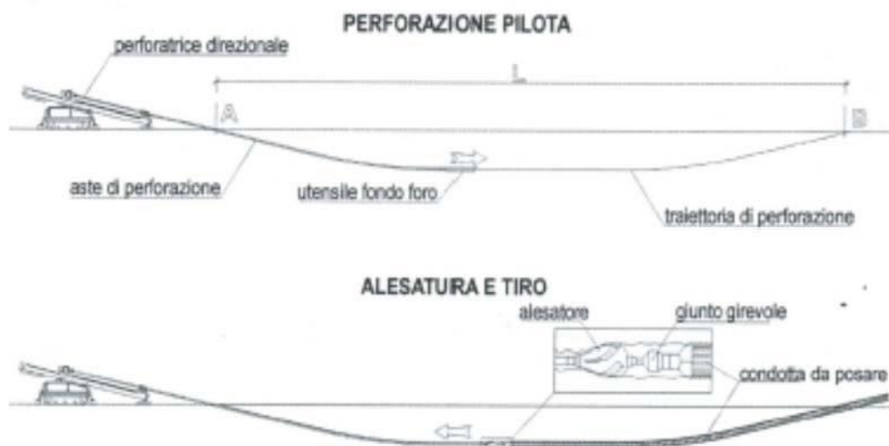
Schema semplificato del sistema di trivellazione T.O.C.
