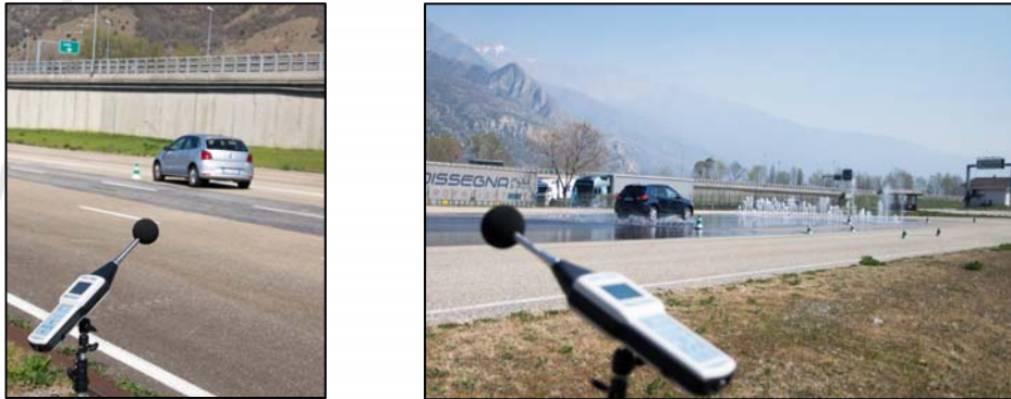
Figura c: Rilievo fonometrico in fase di esercizio
