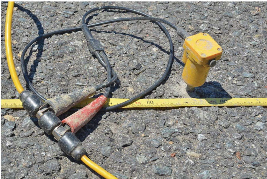
Figura 4 – Geofono verticale SENSOR SM-6/U-B.
