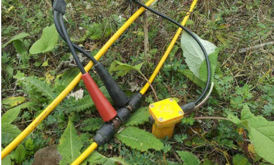
Figura 5 – Geofono verticale SENSOR SM-6/U-B.
