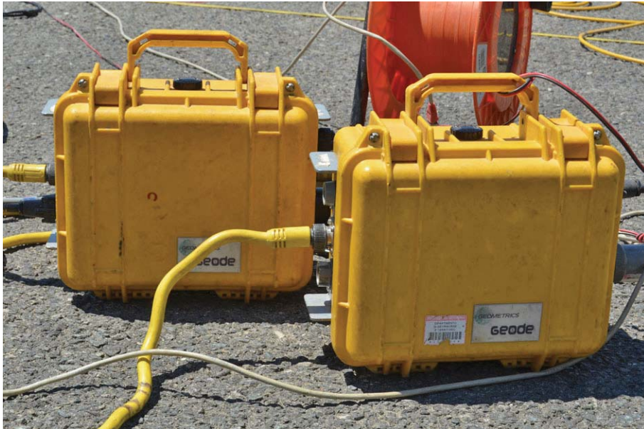
Figura 3 – Sismografi Geometrics Geode.
