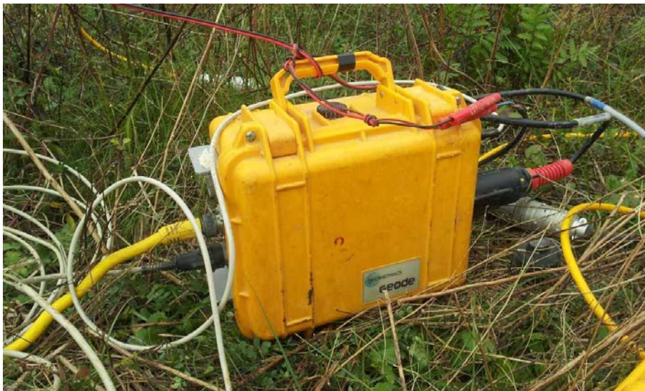
Figura 4 – Sismografo Geometrics Geode.
