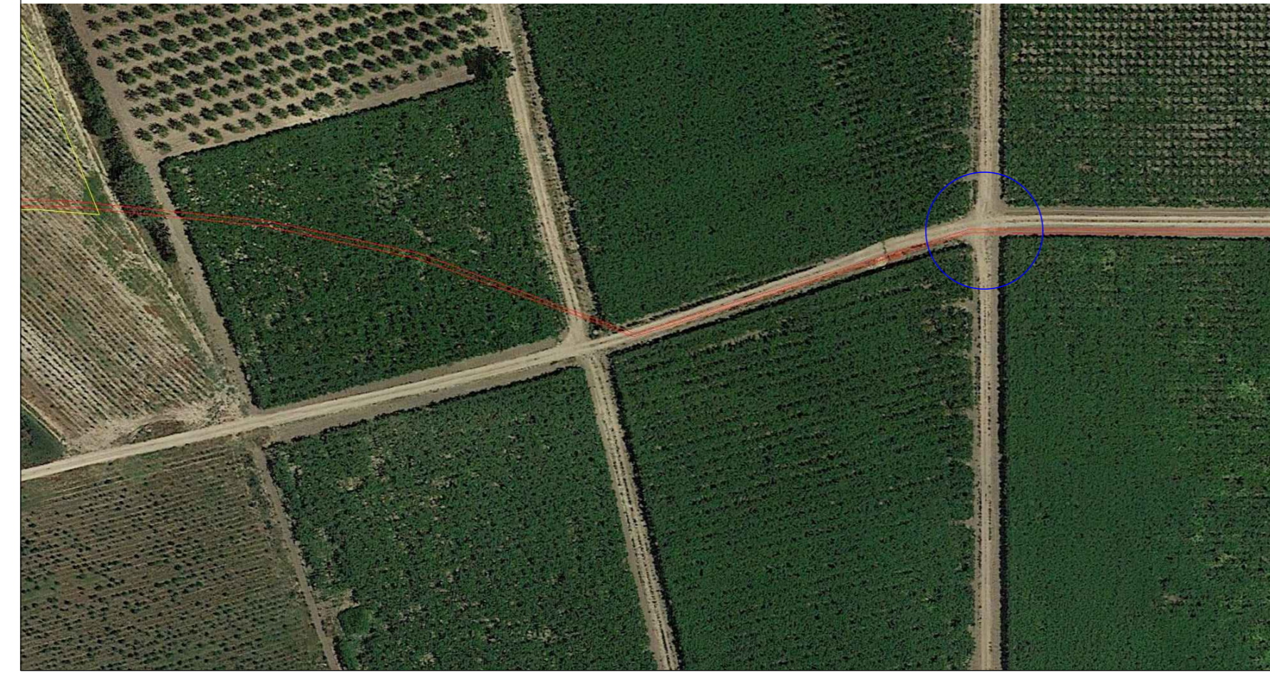
INTERFERENZA 2 - Attraversamento su condotta idrica - "Tipologia T.O.C."
