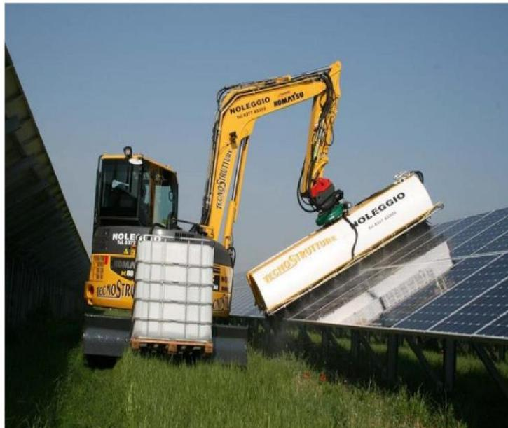
*Figura 1 – Sistema automatizzato lavaggio moduli fotovoltaici*
