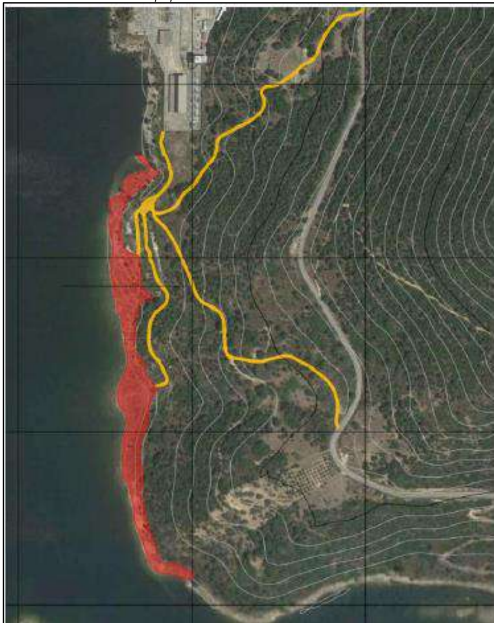
Figura 3.5a Sistemazione dello smarino lungo l'arenile di una porzione di arenile del lago di Cucchinadorza e le strade sterrane interne alla proprietà
