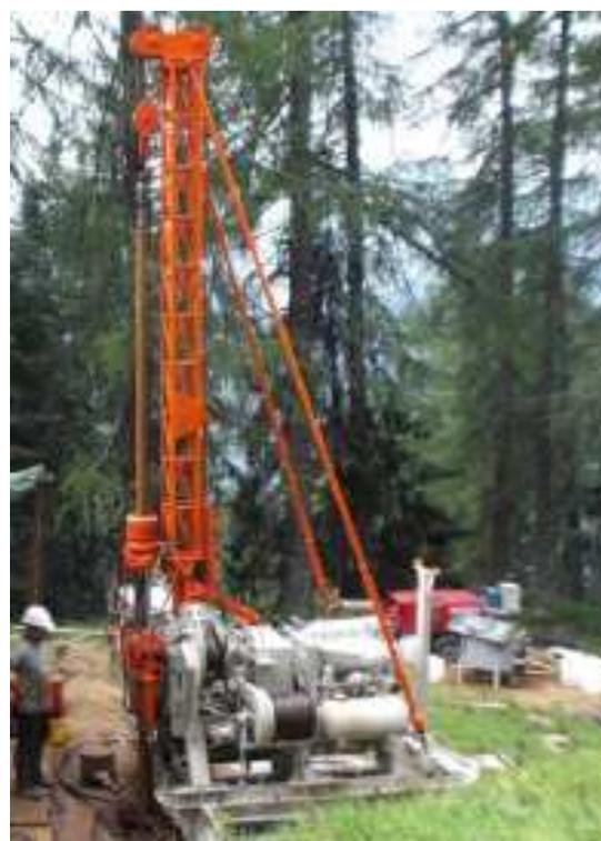
Immagini 12 – 13: Tipologie di sonda Perforatrice idraulica elitrasportabile
