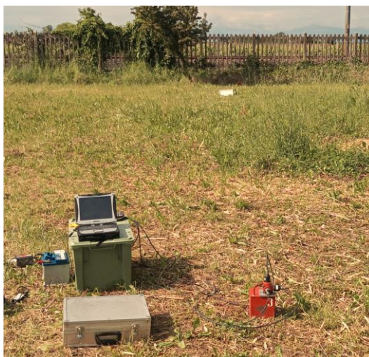
Figura 3-3 Esempio di installazione dell'accelerometro
