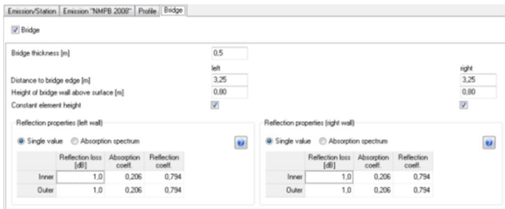
Figura 5 Interfaccia del software SoundPlan nella modellazione acustica dei ponti e viadotti
