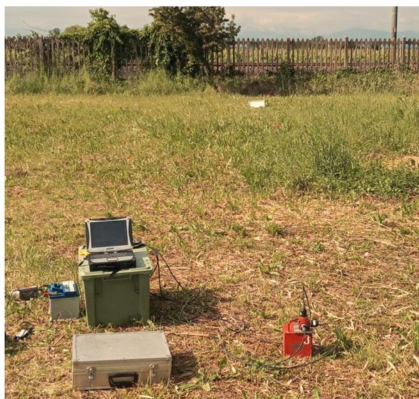
*Figura 3-3 Esempio di installazione dell'accelerometro*
