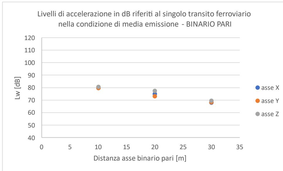
Figura 3-5 Livelli di accelerazione indotti dal singolo transito nella condizione di media emissione sul binario pari a 10, 20 e 30 m dall'asse del binario pari
