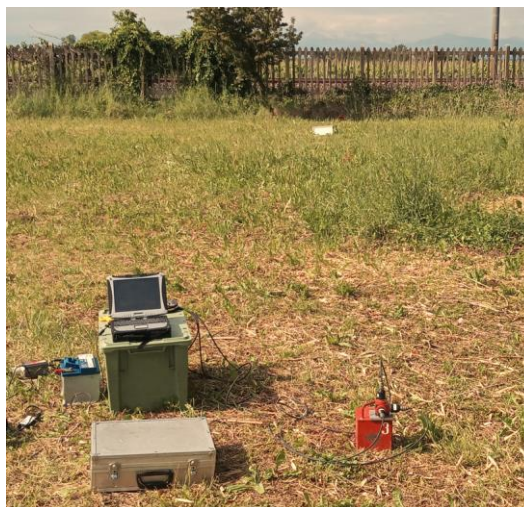
Figura 3-3 Esempio di installazione dell'accelerometro
