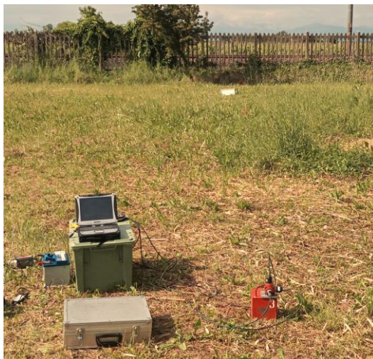
Figura 3-3 Esempio di installazione dell'accelerometro
