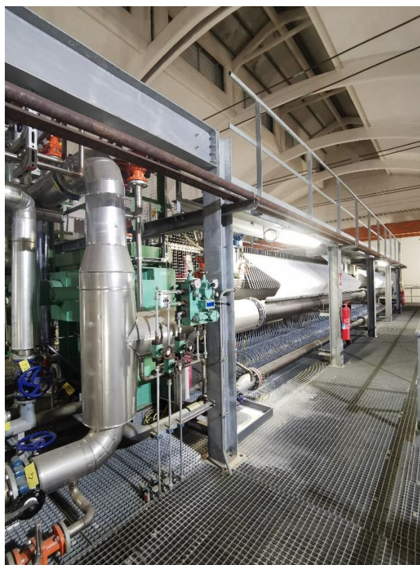
Figura 8 - Immagini fotografiche degli elettrolizzatori cloro soda e cloro potassa, in cui si osservano le singole celle poste in serie con i relativi tubi di alimentazione cloruri e scarico prodotti
