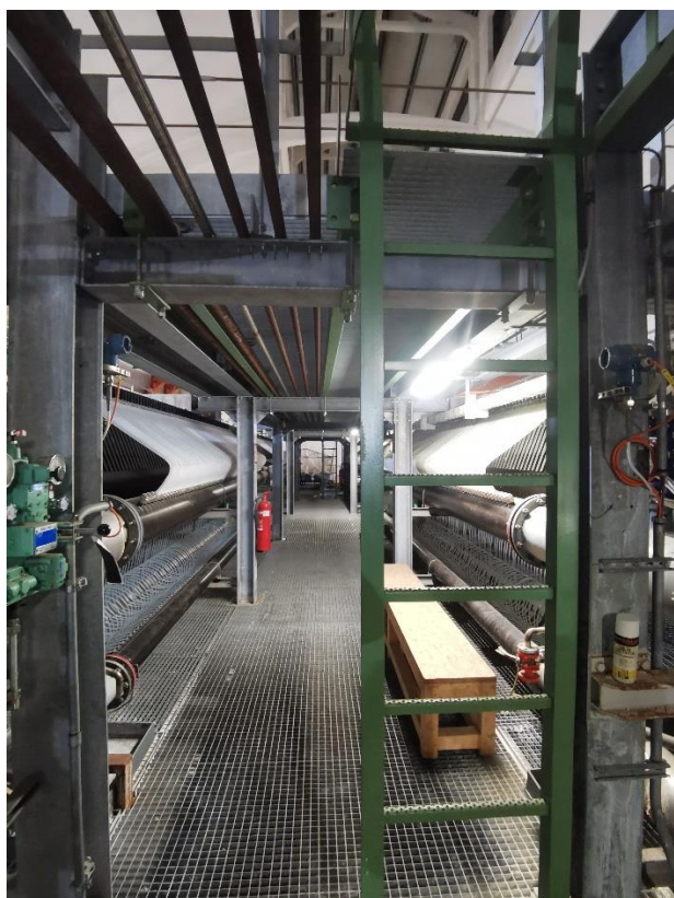
Figura 8 - Immagini fotografiche degli elettrolizzatori cloro soda e cloro potassa, in cui si osservano le singole celle poste in serie con i relativi tubi di alimentazione cloruri e scarico prodotti
