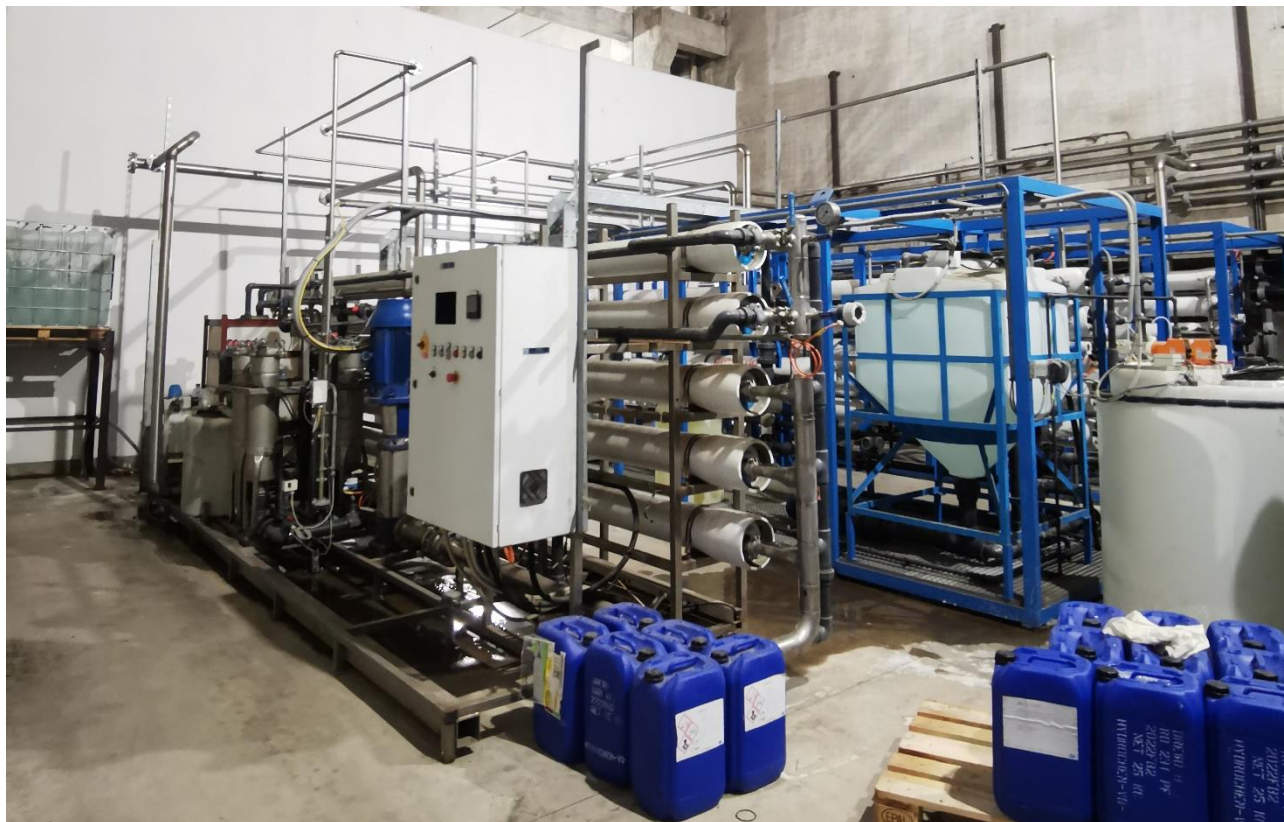
Figura 28 - Impianto osmosi per la produzione di acqua demineralizzata a servizio di diversi processi, tra cui processo di elettrolisi
