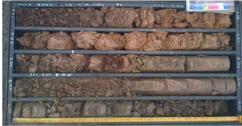
Figura 55. Depositi antropici (h) ed eluvio-colluviali (e-c) intercettati nel sondaggio S4_DH tra le profondità di 0-4,6m (cassa n° 1). Si noti la presenza di una significativa componente limosa nel deposito.
