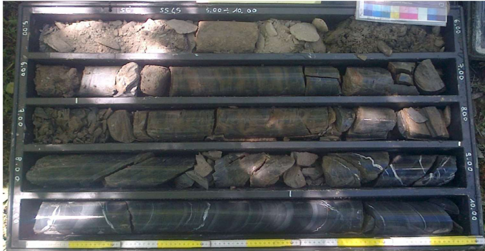
Figura 53. Substrato litoide alterato intercettato nel sondaggio S5_DH tra le profondità di 5,35-8,85m (cassa n° 2).
