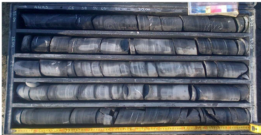
Figura 54. Substrato litoide non alterato intercettato nel sondaggio S8_DH tra le profondità di 25-30m (cassa n° 6).
