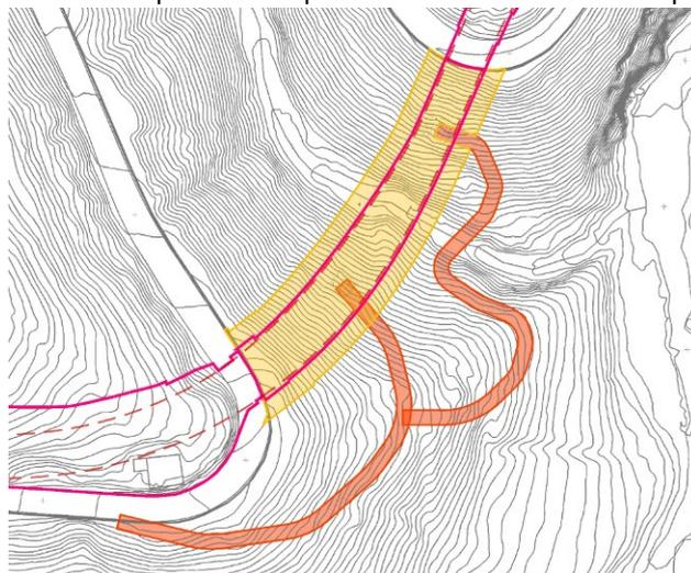
*In giallo è rappresentato il perimetro dell'area di cantiere operativo. Estratto Planimetria aree di cantiere e viabilità di cantiere "TO0CA00CANPL01A".*
