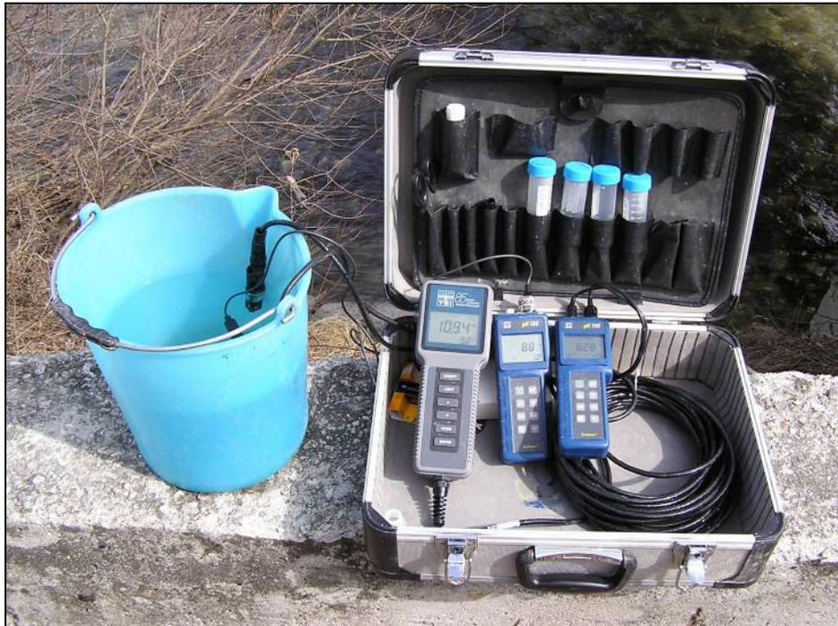
*Set di strumenti per il rilevamento in situ dei parametri chimico-fisici.*
