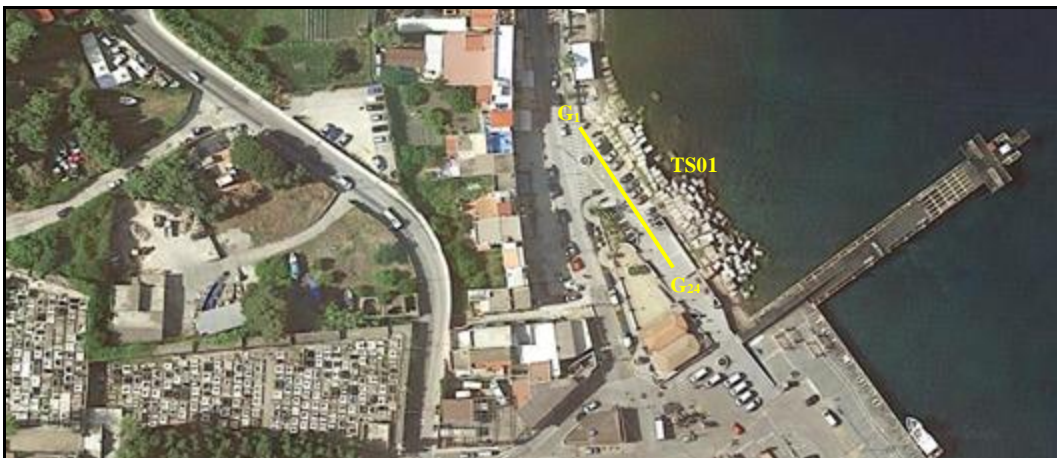
FIG. 01 – UBICAZIONE DELLE INDAGINI GEOFISICHE (TOMOGRFIA SISMICA.)
