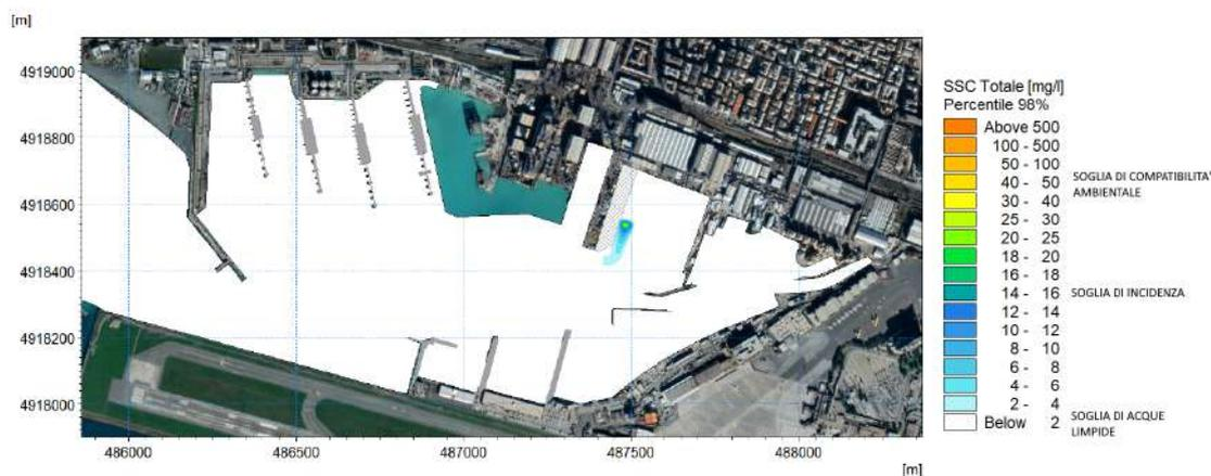
Figura 6-98 Mappa del 98-esimo percentile di concentrazione di sedimento in sospensione nello strato di fondo durante le operazioni di vibroinfissione dei pali relativamente all'opera D (Layout 4) – Scenario idrodinamico 6 (vento dal III quadrante, intensità corrispondente al 50esimo percentile)
