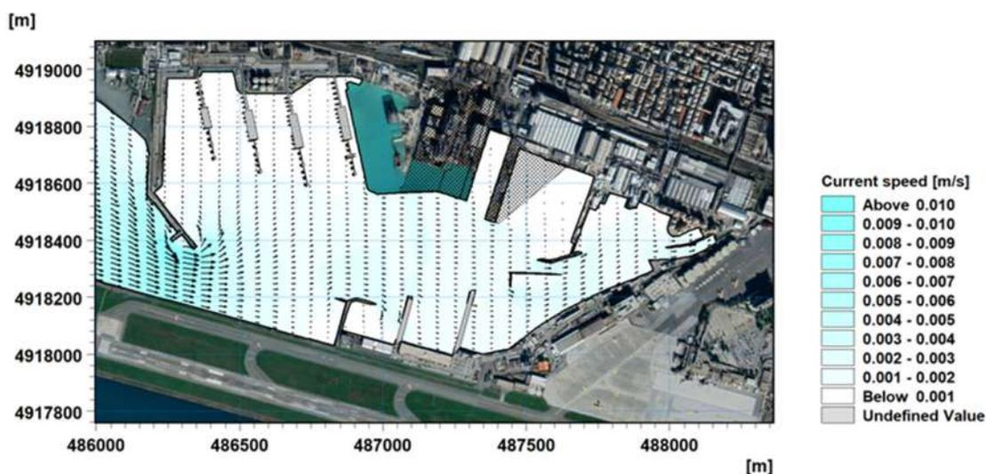
Figura 5-91 Layout 5 – configurazione di progetto finale – Scenario meteomarinario 1 - Campo idrodinamico generato dalla marea astronomica in fase crescente (20.08.2020 17:30)
