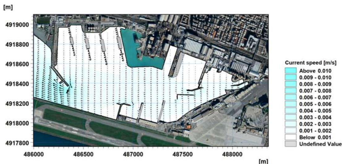
Figura 5-52 Layout 3 – seconda fase di cantiere per il dragaggio con Opera B e Opera C realizzate – Scenario meteomarinario 1 - Campo idrodinamico generato dalla marea astronomica in fase decrescente (20.08.2020 23:30)
