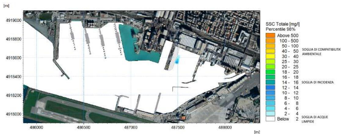
Figura 6-104 Mappa del 98-esimo percentile di concentrazione di sedimento in sospensione nello strato di fondo durante le operazioni di vibroinfissione dei pali relativamente all'opera D (Layout 4) – Scenario idrodinamico 9 (vento dal IV quadrante, intensità corrispondente al 98esimo percentile)
