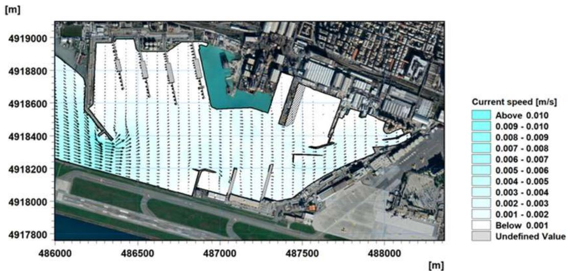
Figura 5-51 Layout 3 – seconda fase di cantiere per il dragaggio con Opera B e Opera C realizzate – Scenario meteomarinario 1 - Campo idrodinamico generato dalla marea astronomica in fase crescente (20.08.2020 17:30)
