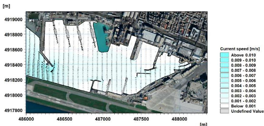
Figura 5-12 Layout 1 – fase di cantiere per la vibroinfissione dei pali relativi al bacino di carenaggio in progetto (Opera C) – Scenario meteomarinario 1 - Campo idrodinamico generato dalla marea astronomica in fase decrescente (20.08.2020 23:30)
