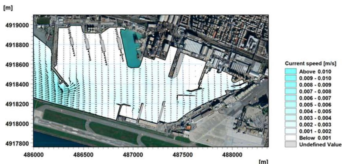
Figura 5-11 Layout 1 – fase di cantiere per la vibroinfissione dei pali relativi al bacino di carenaggio in progetto (Opera C) – Scenario meteomarinario 1 - Campo idrodinamico generato dalla marea astronomica in fase crescente (20.08.2020 17:30)
