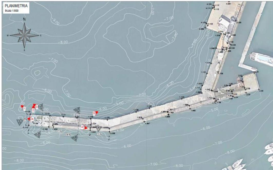
Figura 2-17: Planimetria del molo Tankoa con evidenza del tratto terminale da demolire
