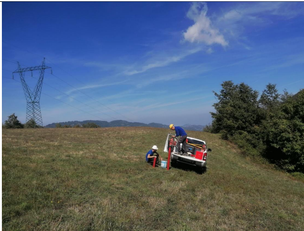
Esecuzione carotaggio P. 103
