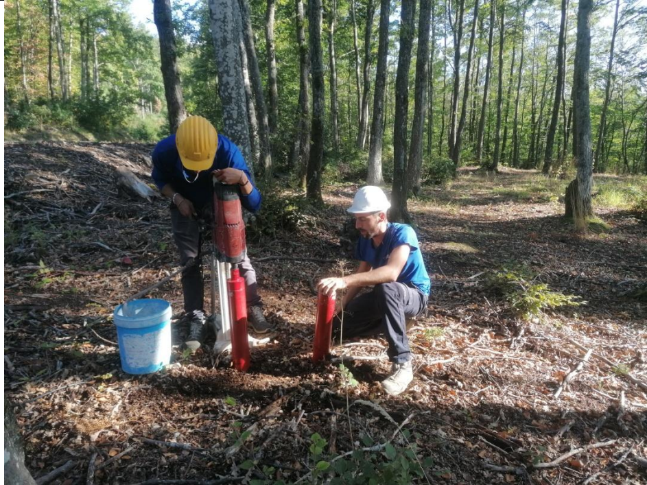
Esecuzione carotaggio P. 117
