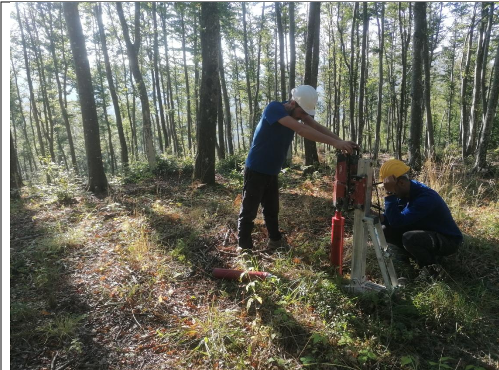
Esecuzione carotaggio P. 118
