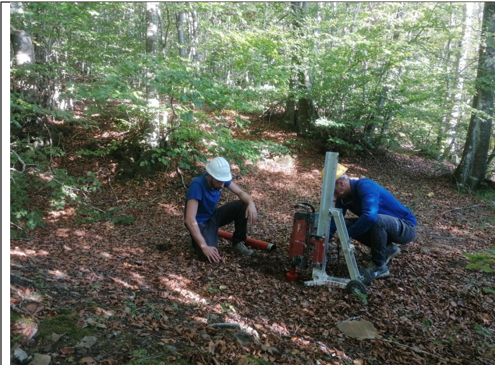
Esecuzione carotaggio P. 119
