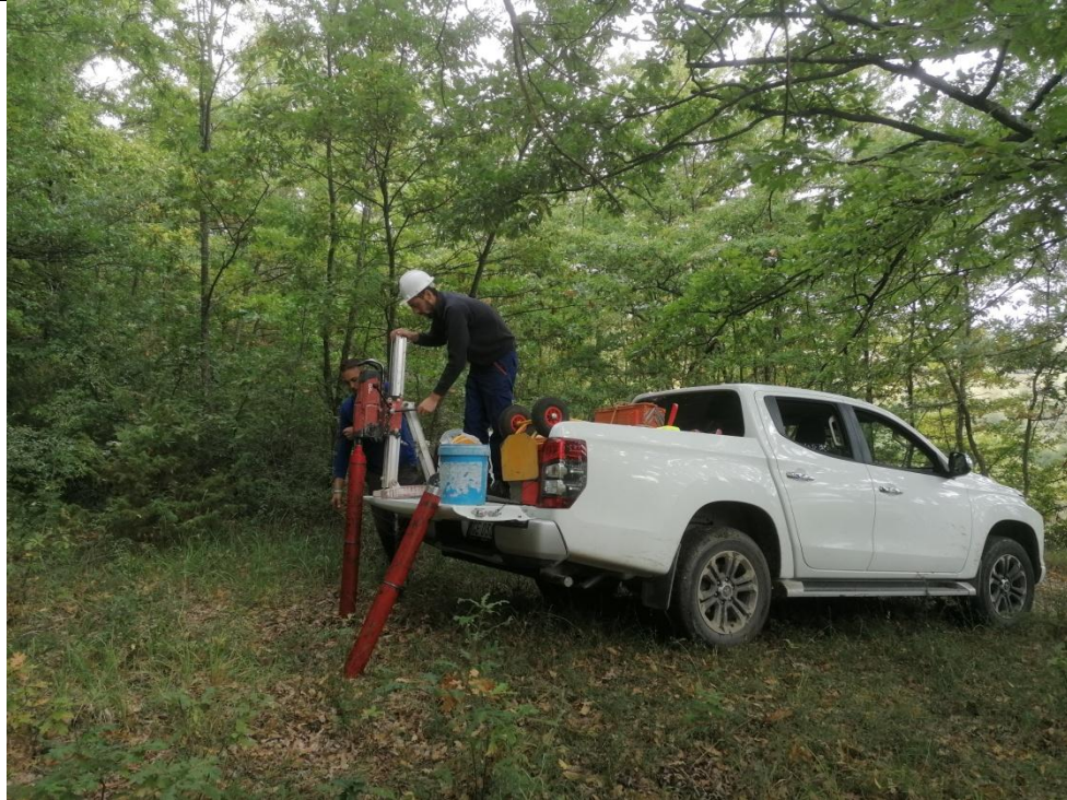
Esecuzione carotaggio P. 11H
