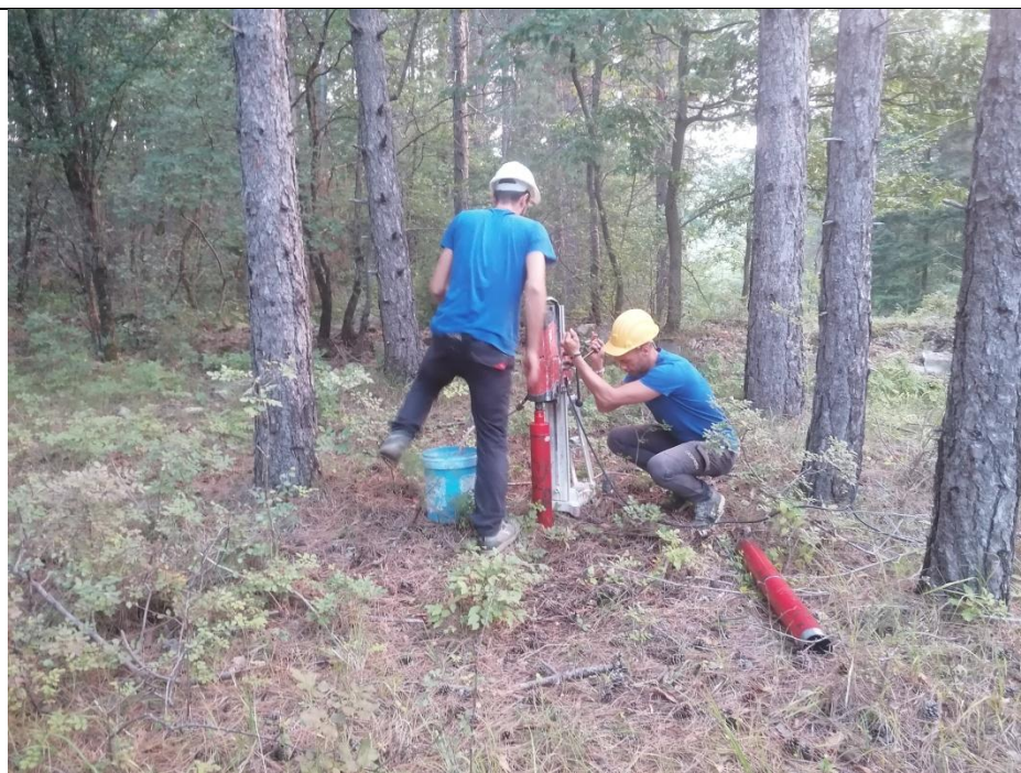
Esecuzione carotaggio P. 159
