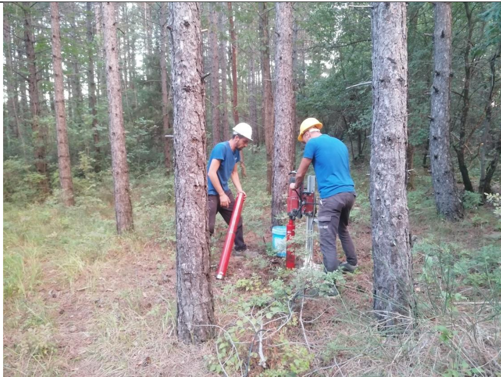
Esecuzione carotaggio P. 159
