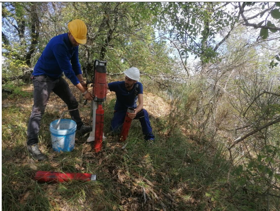
Esecuzione carotaggio P. 165
