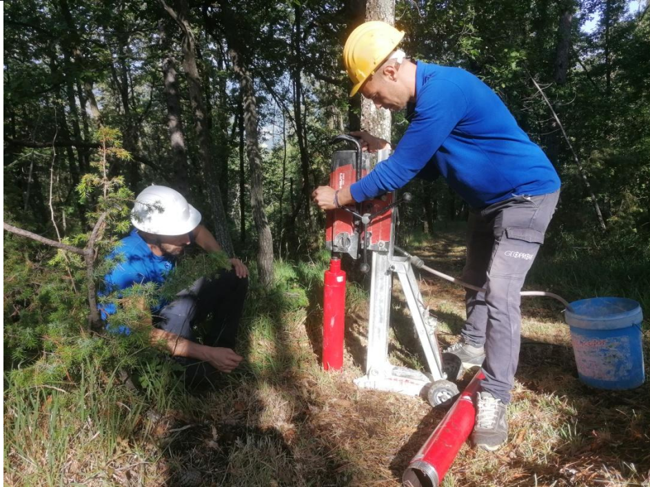
Esecuzione carotaggio P. 18G
