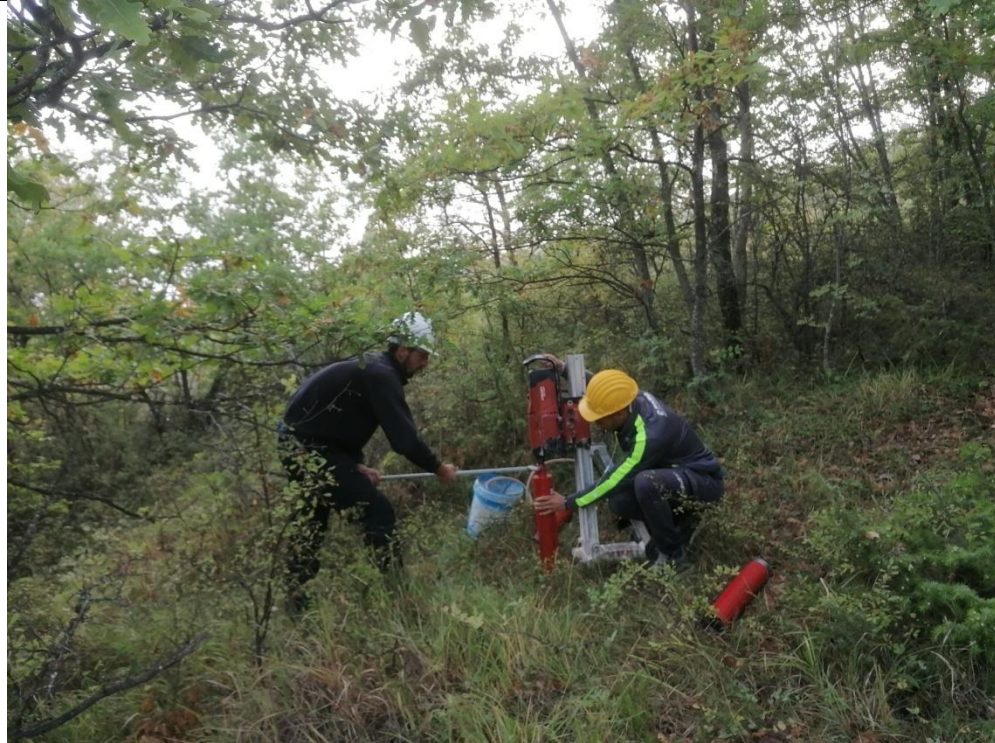
Esecuzione carotaggio P.79
