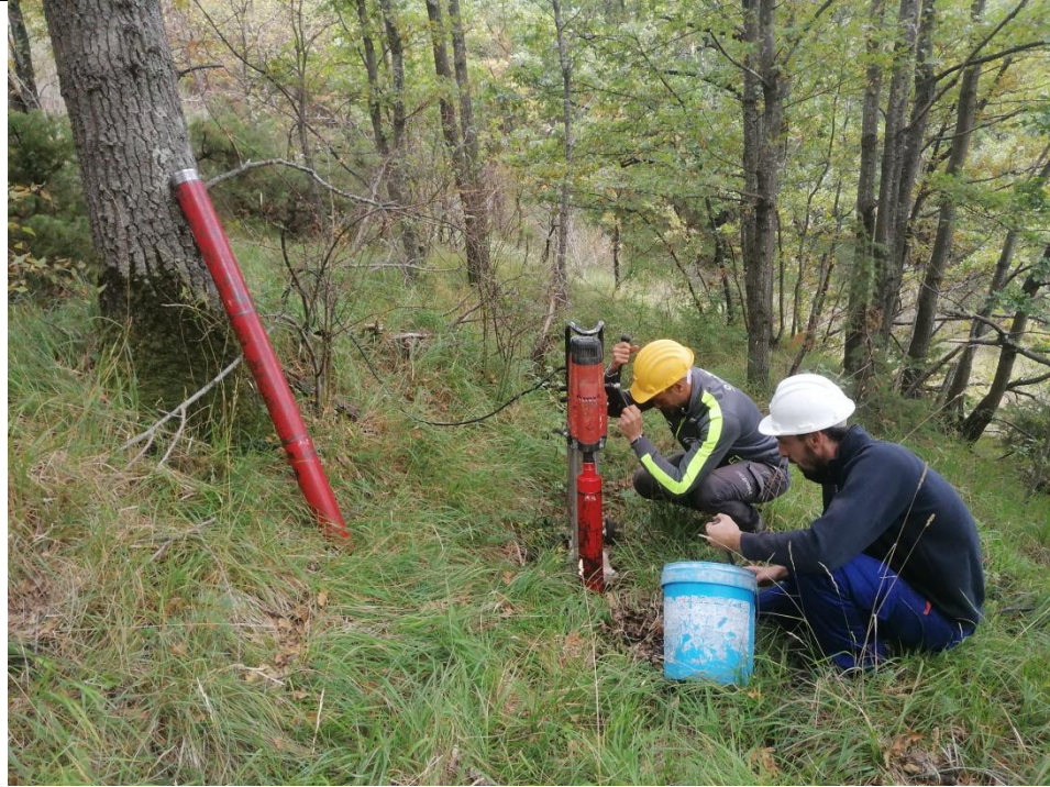
Esecuzione carotaggio P. 7H
