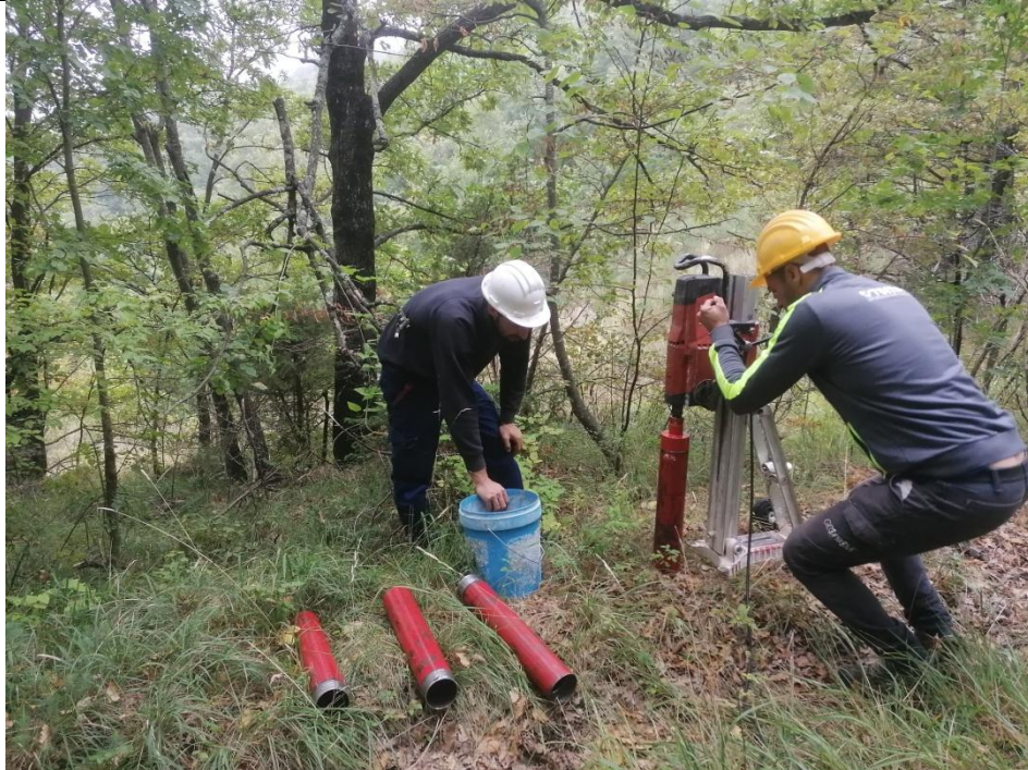
Esecuzione carotaggio P. 9H
