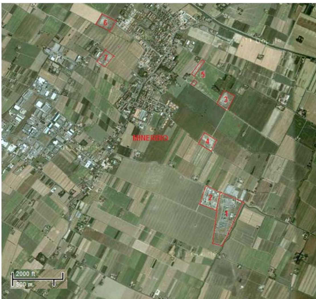
Figura 2.1-1 – Principali infrastrutture della Concessione Minerbio Stoccaggio (base: immagine satellitare Google): (1) centrale compressione; (2) centrale trattamento; (3) cluster B; (4) cluster C; (5) cluster E-E1; (6) cluster A; (7) cluster D
