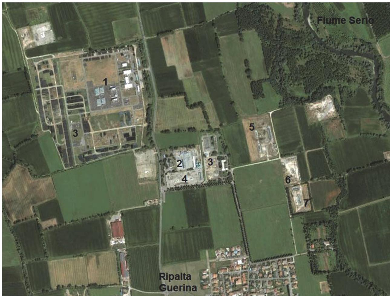
**Figura 2.1-1 – Principali infrastrutture della Concessione Ripalta Stoccaggio – situazione impiantistica attuale (base: Google Earth): (1) impianto (area) di compressione; (2) attuale impianto (area) di trattamento; (3) aree Snam Rete Gas; (4) cluster A; (5) cluster C; (6) cluster B; (7) cluster D**
