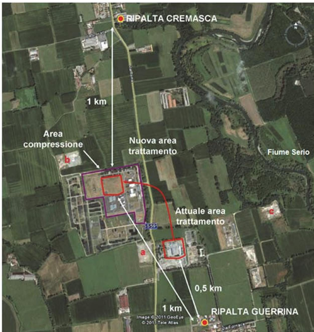
Figura 2.1-2 – Concessione Ripalta Stoccaggio: localizzazione del nuovo impianto (area) di trattamento e nuovi pozzi Ripalta 64dir (a), Ripalta 65Or (b) e Ripalta 66Or-67Or (c) (base: Google Earth)
