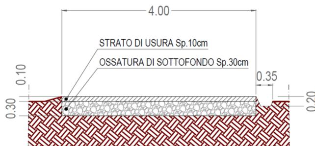
Fig. 3.10 - Sezione di dettaglio della strada interna
