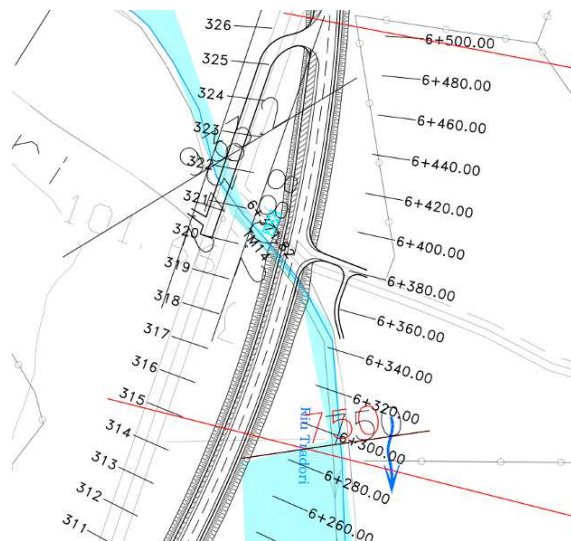
Figura - Situazione Ante Operam, stato di fatto Riu_Tradori
