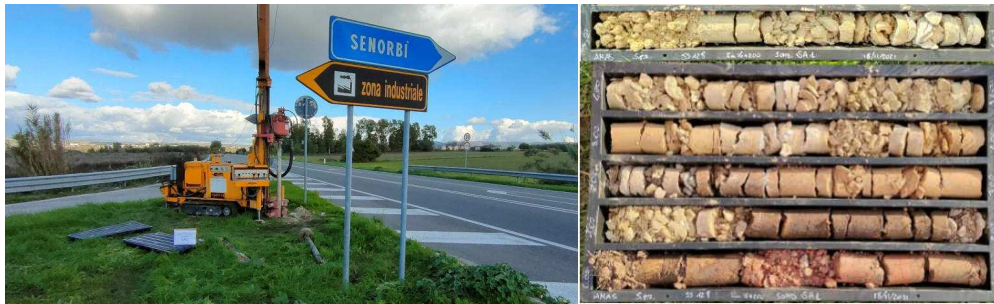
Figura 76. Sondaggio SA1, 0.00 – 6.00 m
