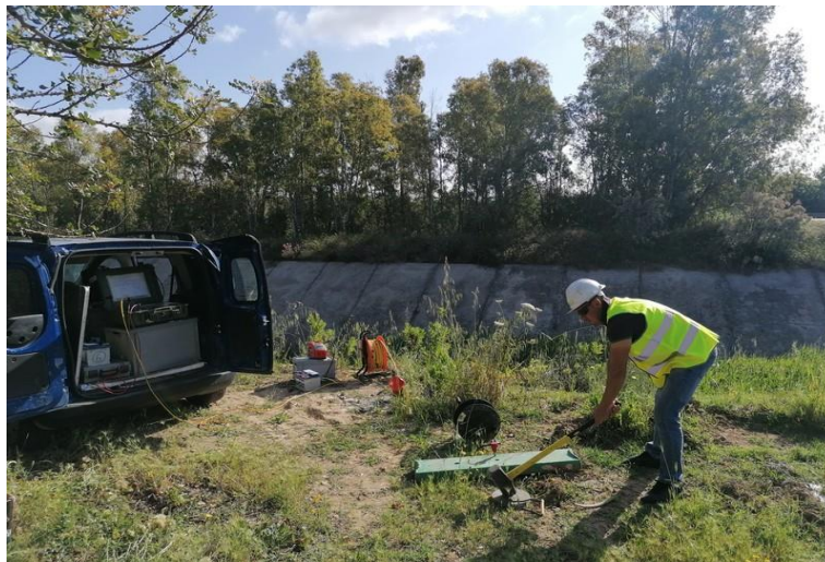
Fase acquisizione onde "P"
