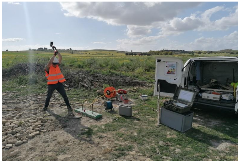
Fase acquisizione onde "P"
