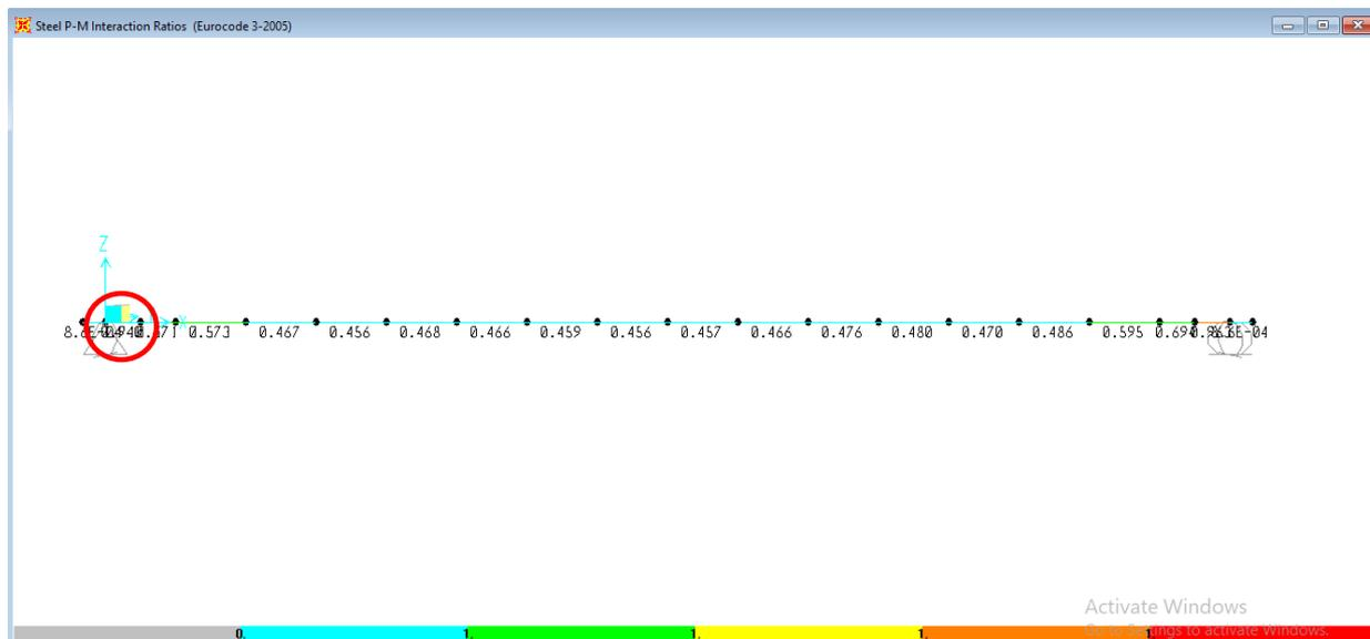
Figura 6.59. – Combinazioni SLU – Verifiche di resistenza a pressoflessione - Coefficienti di utilizzo – Trave-catena
