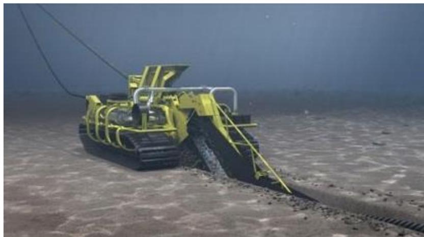
Figura 5-15 - Sistemi protezione dei cavi per interrimento
