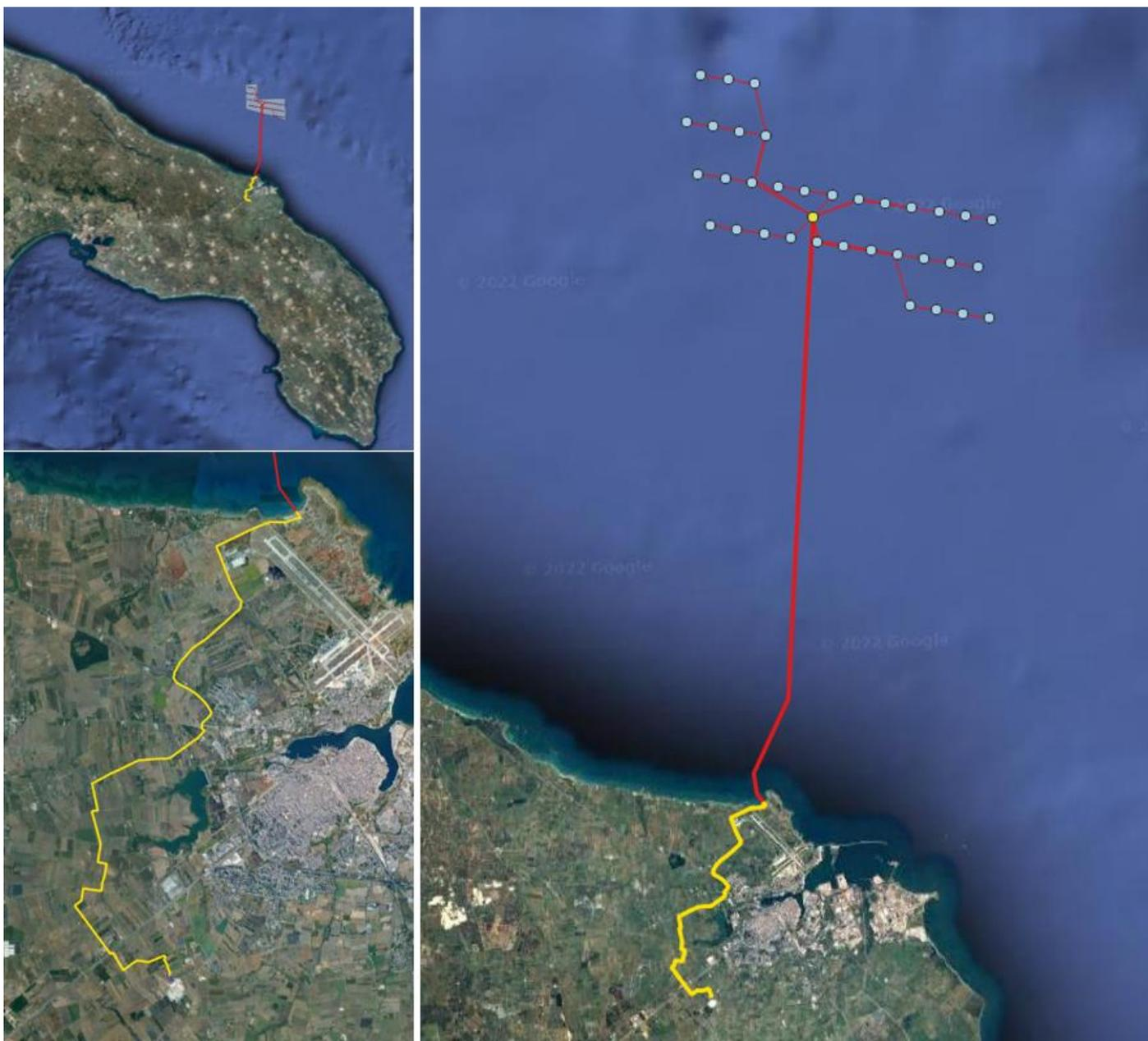
Figura 3-1 - Individuazione dell'impianto e delle relative opere su immagine satellitare
