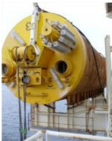
Figura 5-8 - Illustrazione di palo infisso per aspirazione
