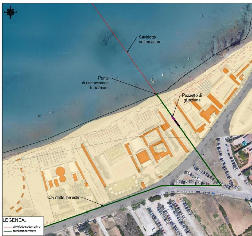
Figura 5-18 - Pozzetto di giunzione allo sbarco (Transition Joint Bay - TJB)
